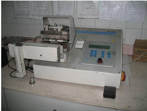
Resim 1.22: Masa üstü ısı yapıştırma makinesi
