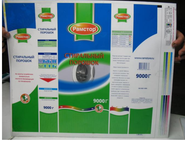
Resim 1.3: Kromolin çıktısı üzerinde yazı ve dizayn düzenleme kontrolü
