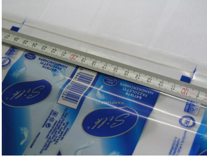
Resim 1.14: Metre ile fotosel aralığının ölçülmesi 16.5 cm
