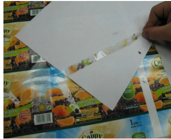
Resim 1.37: Şeffaf bant ile adezyon kontrolü
