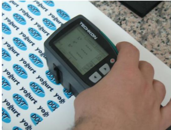
Resim 2.2 : Spektrofotometre ile ölçüm
