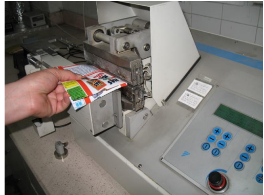
Resim 1.23: Aynı malzemenin birbirine ısı yapıştırılması
