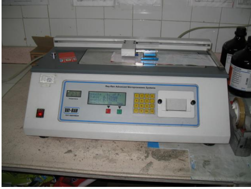
Resim 2.12: Yüzey sürtünme test makinesi
