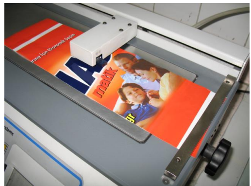
Resim 2.11: Baskılı malzemenin makineye takılıp mandal sıkıştırılması
