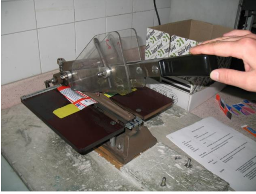
Resim 2.18: Test için bir inçlik malzeme kesim makinesi
