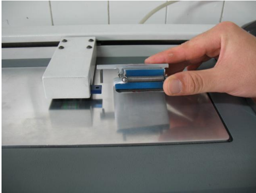
Resim 2.8: Test parçasının test makinesine takılması
