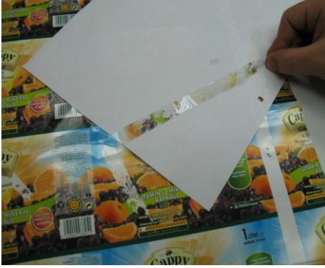
Resim 1.1: Şeffaf bant ile adezyon kontrolü Resim 1.2: Bant üzerine çıkmış adezyon zayıflıkları
