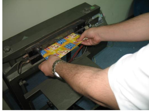
Resim 1.25: Aynı malzemenin birbirine ısı yapıştırılması
