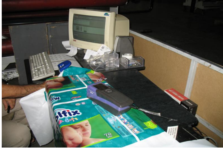
Resim 1.7: Bilgisayar bağlantılı spektrofotometre ile renklerin sayısal değeri olarak kontrol altına alınması
