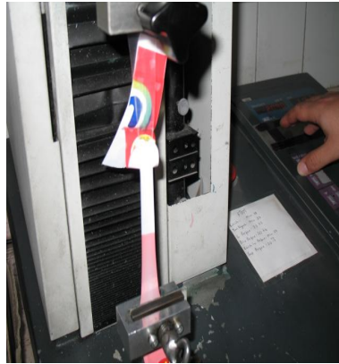
Resim 2.17: Gerilme kopmada bir parçanın test edilmesi
