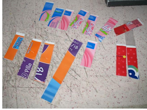
Resim 2.19: Bir inçlik ölçü ile kesilmiş test parçaları
