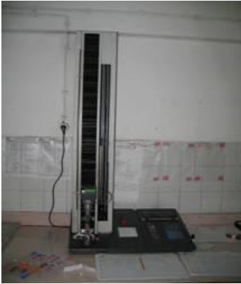
Resim 2.16: Gerilme kopma test makinesi
