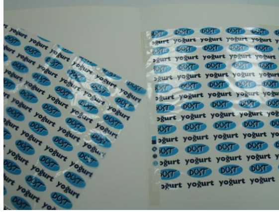
Resim 2.1 : Onaylı kromolin çıktısı ile baskılı parçanın yan yana kontrolü
