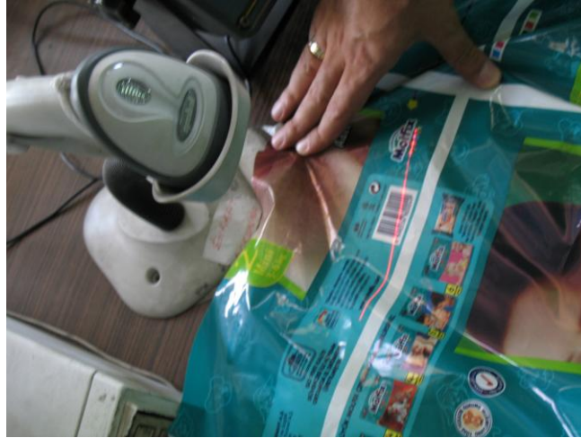
Resim 1.13: Barkod okutma ve numarasını kontrol etme
