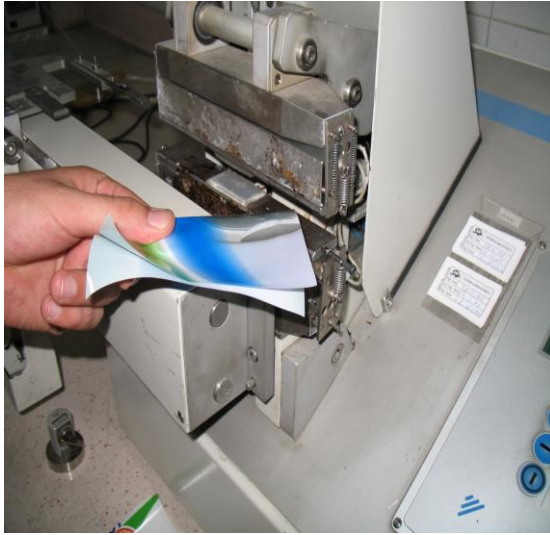
Resim 1.26: Malzemeye ısı yapıştırma uygulama
