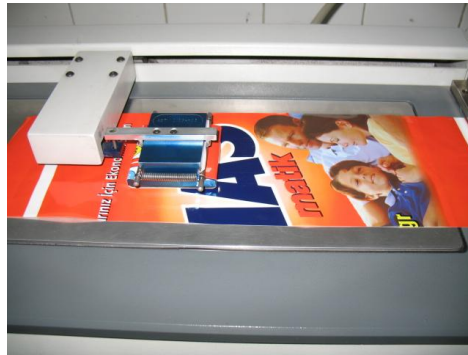
Resim 2.15: Basılı malzemelerin dış yüzeylerinin birbirlerine olan sürtünmelerinin testi
