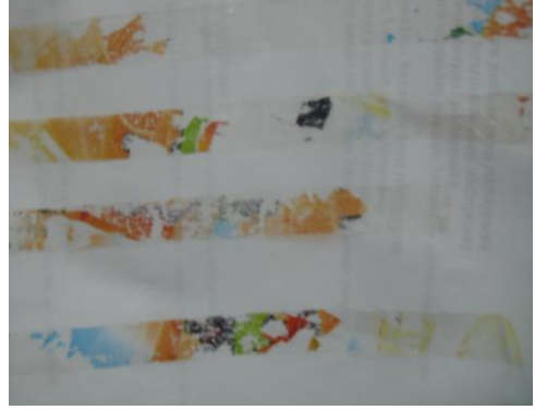
Resim 1.1: Şeffaf bant ile adezyon kontrolü Resim 1.2: Bant üzerine çıkmış adezyon zayıflıkları
