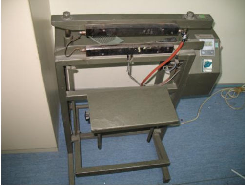
Resim 1.24: Ayaklı ısı yapıştırma makinesi
